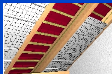
Montáž izolačních EPS tvarovek
